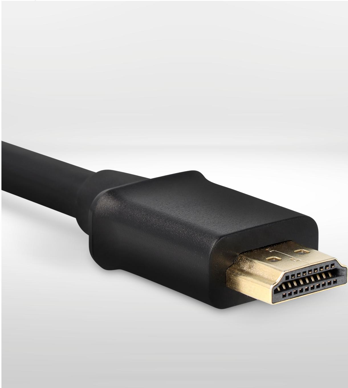
缩写 HDMI<sup>®</sup> 代表高清多媒体接口。与VGA、DVI 或 SCART HDMI<sup>®</sup> 等模拟接口相比，它是一种数字多媒体接口，可通过一根线缆传输音频和视频信号，是数字传输未压缩视频和音频数据的常用标准。目前的HDMI<sup>®</sup> 2.1 标准支持高达 45 Gbit/s 的带宽和 60 Hz 的8K 分辨率。
